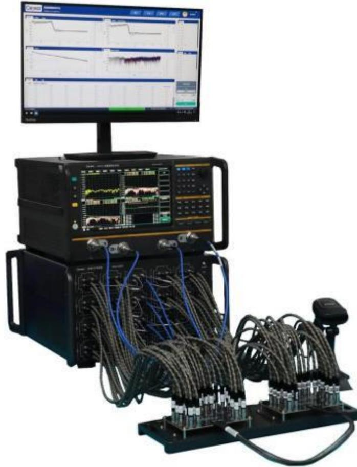
图 11 GPMI 矢网及线缆测试解决方案
